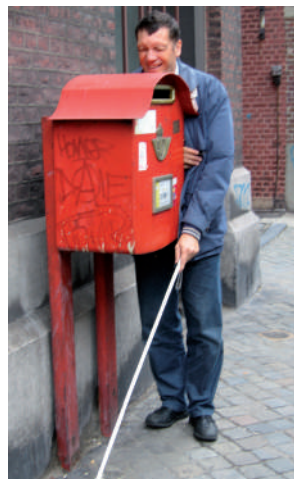
✗ Detectie met blindenstok onmogelijk
